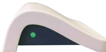
Bild 5. Lampan på sidan av enheten ska visa fast grönt sken.
