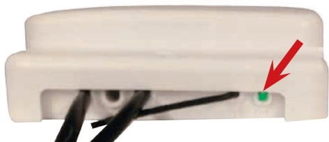
Bild 4. Indikationslampan på Remote-enheten ska blinka efter inkoppling.
